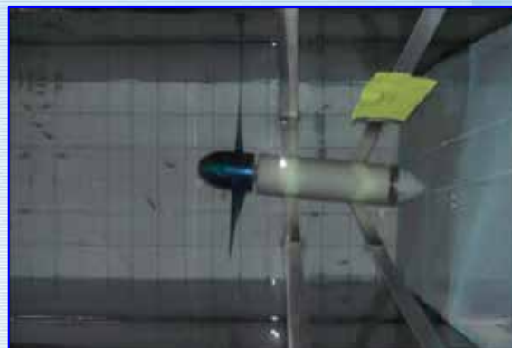
タービンブレード周辺の魚の行動の観察 (Observation of the fish motion around the turbine blades)
