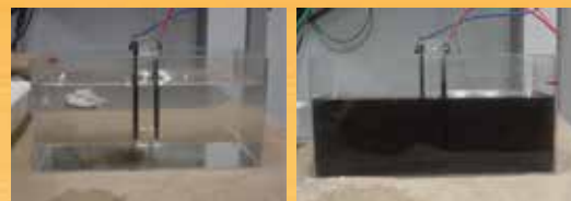
炭電極による電気分解 (Electrolysis using charcoal electrodes)
