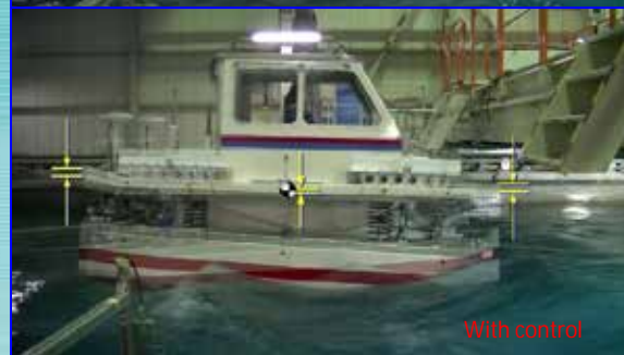
水槽模型実験におけるキャビン動揺抑制の様子 (The motion of the cabin in water tank testing)
